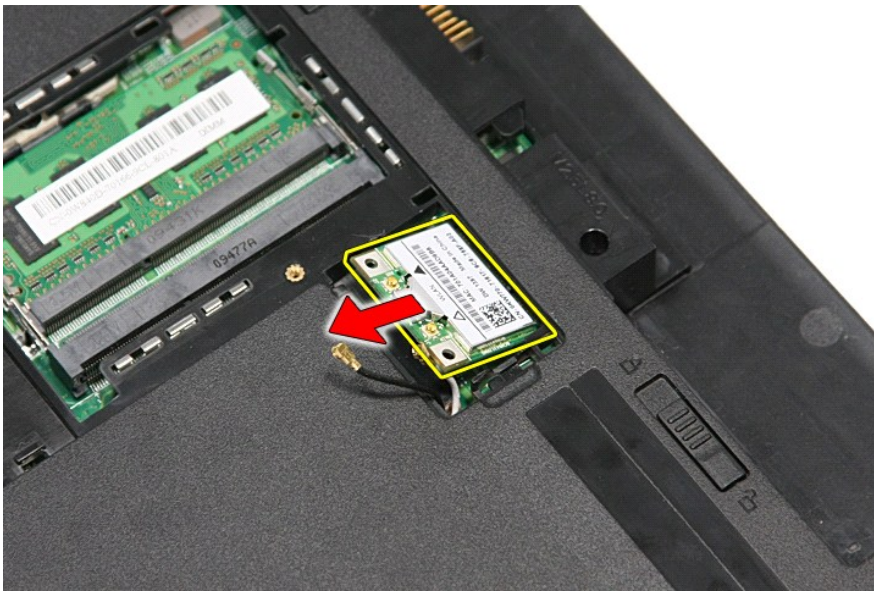
6. ดึงการ์ด WLAN ออกจากขั้วต่อนบนเมนบอร์ด และถอดออกจากคอมพิวเตอร์
