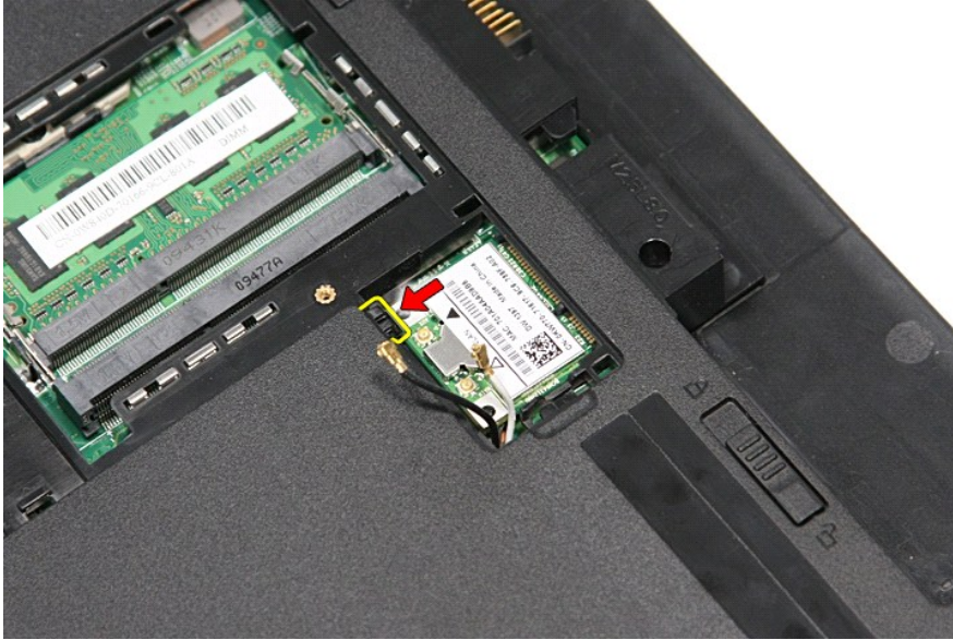
6. ดึงการ์ด WLAN ออกจากขั้วต่อนบนเมนบอร์ด และถอดออกจากคอมพิวเตอร์
